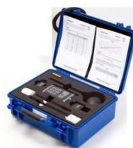
De plus, ils disposent d'écrans LCD donnant toutes informations utiles (valeurs sur l'axe X, Y, Z, isotropique, moyenne, max, min) et permettent **d'enregistrer un grand nombre de données**, en points uniques ou en surveillance longue durée.
